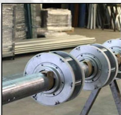
Eje fabricado con poleas metálicas con rodamientos y fleje.
