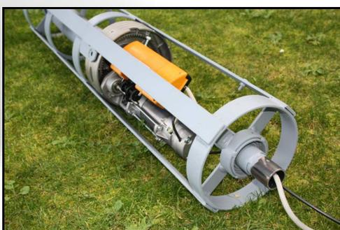
Eje reforzado elaborado con tubo central de hierro, muelles de torsión de acero al carbono y poleas fabricadas con pletinas y rodamientos. Está especialmente indicado para persianas de gran tamaño o de un peso considerable.
