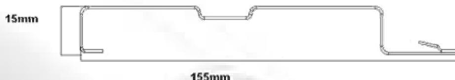
La chapa perfica tiene una ventaja importante, singular e innovadora; se trata de que este modelo facilita la sujeción de la chapa al portal mediante un diseño especial de pestañas que permite ocultar el elemento de sujeción empleado, ya sean tornillos o remaches.
